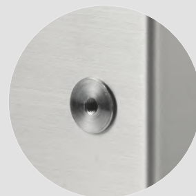
INSERTS ACHTERWAND. Voor bevestiging van de behuizing aan de muur (of rechtstreeks op apparatuur) zonder dat er machinale bewerkingen nodig zijn die de beschermingsgraad kunnen wijzigen.
